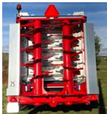
SYSTÈME D'ÉPANDAGE ROBUSTE POUR UN ÉMIETTAGE FIN ET PRÉCIS (Φ 900)
