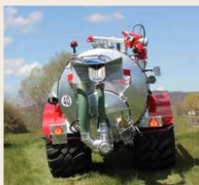
ENCASTREMENT PERMETTANT DE MODIFIER LA LARGEUR DE VOTRE ÉQUIPEMENT (2,55 - 2,70 M...)
