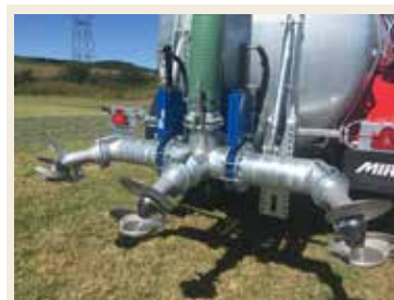
TRIPLE BUSES DE PRÉCISION AVEC VANNES POUR SÉPARATION DE TRONÇONS
