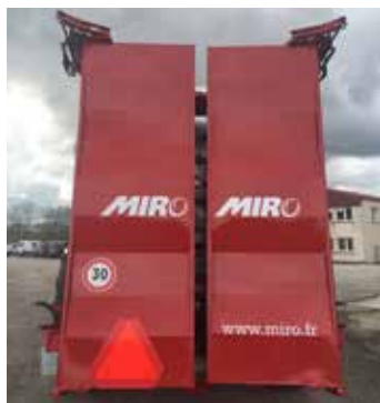
PROTECTION DES HÉRISSONS POUR LA CIRCULATION DES MACHINES SUR LA ROUTE. (SURTOUT UTILISÉ EN SUISSE)
