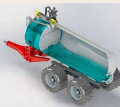
REPORT DE CHARGE ET TIMON EN V AMÉLIORE LE PILOTAGE ET LE CONFORT SUSPENSION HYDRAULIQUE ET HAUTEUR RÉGLABLE
